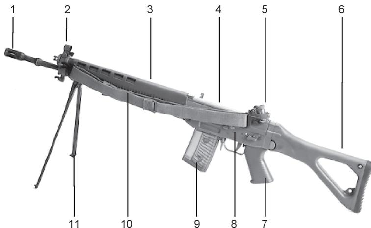
Abbildung 1: Hauptbestandteile des 5,6 mm Stgw 90
