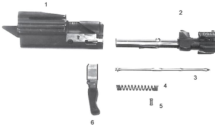
Abbildung 4: Verschluss zerlegt
